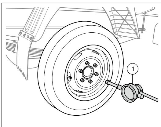
2. 检查车轮的径向，轴向圆跳动。
