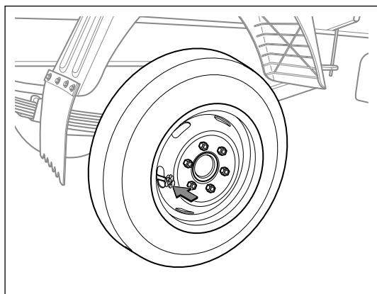
(b). 用肥皂水检查轮胎气门嘴是否漏气。
