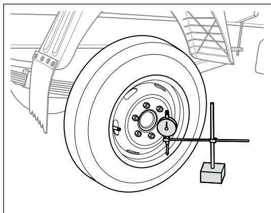
(d). 安装百分表①并缓慢转动物轮，测量前后轮的径向圆跳动值，如超出极限值，请更换车轮。
